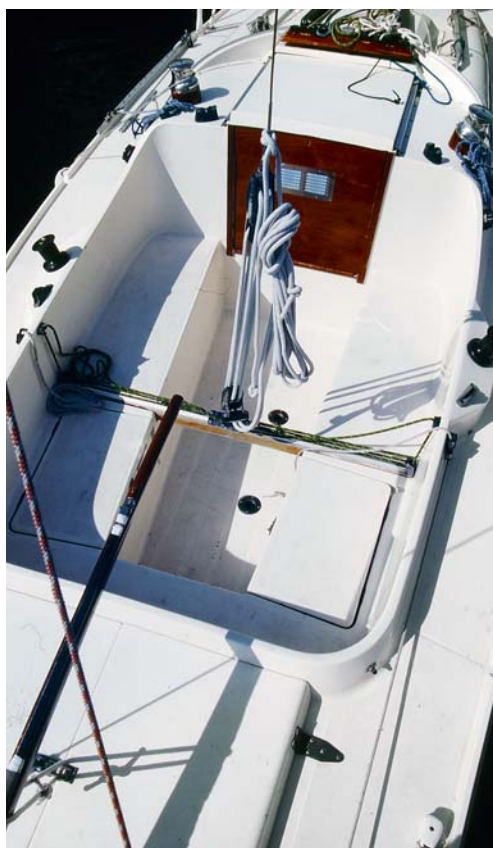
IF'eren har et meget enkelt selvlænsende cockpit. De relativt høje karme gør det velegnet til tursejladser med børn. Den ene af de to store luger på agterdækket dækker over en motorbrønd.
